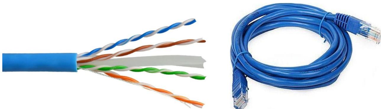
Consiste de quatro pares de fios trançados blindados ou não, e envolto de um revestimento externo flexível. Eles são trançados para diminuir a interferência eletromagnética externa e interna – quanto mais giros, maior a atenuação. Este é o cabo mais utilizado atualmente por ser o mais barato de todos e ser bastante flexível. Esse cabo cobre distâncias menores que o cabo coaxial e utiliza um conector chamado RJ-45 (**Memorizem!**).
