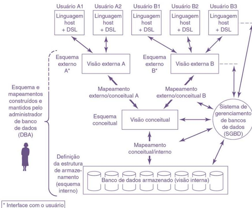
Figura 13 - Arquitetura detalhada do sistema
