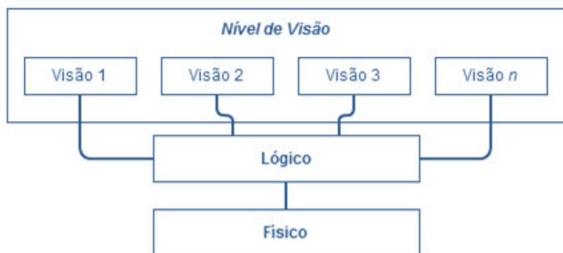
Figura 12 - Os 3 níveis de abstração: Visão, lógico e físico.
