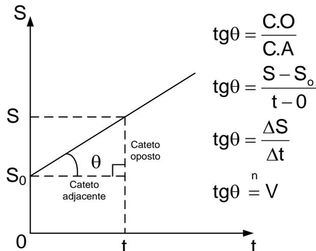
Portanto, a velocidade constante do móvel em MRU é numericamente igual à tangente do ângulo de inclinação da reta do gráfico (S x t).
