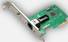
Equipamento de rede de comunicação bidirecional (entrada e saída de dados) conectado à placa-mãe do computador. Toda placa de rede possui um número identificador chamado Endereço MAC (48 Bits).
