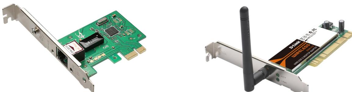
**Galera, essa é a famosa Placa de Rede<sup>2</sup>!** Se vocês olharem na parte de trás do gabinete de um computador, vocês a verão (provavelmente com o cabo azul de par trançado conectado a ela). Ela é o recurso de hardware mínimo que deverá estar instalado no computador para permitir uma comunicação bidirecional – transmissão e recebimento de dados – com os demais elementos da rede. Agora vejam que coisa interessante...
