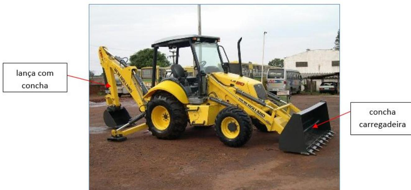
Em obras rodoviárias, esse equipamento é bastante utilizado na escavação de valas para a implantação de drenos profundos, sendo pouco utilizado nas operações de terraplenagem propriamente ditas.
