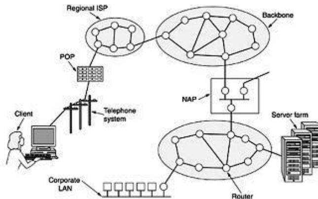
A representação indicada por Corporate LAN é um exemplo de topologia de barramento de rede multiponto em que todos os dispositivos conectam-se por um cabo comum ou por links de comunicação.
