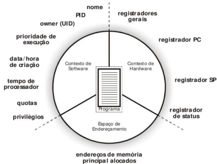
Existe uma estrutura de dados no núcleo do sistema operacional que serve para armazenar a informação necessária para tratar um determinado processo. Trata-se do **Bloco de Controle do Processo** (PCB - *Process Control Block*). Como o PCB possui informações críticas do processo ele deve ficar armazenado em uma área da memória protegida do acesso de usuários. Geralmente as informações contidas em um PCB incluem:
